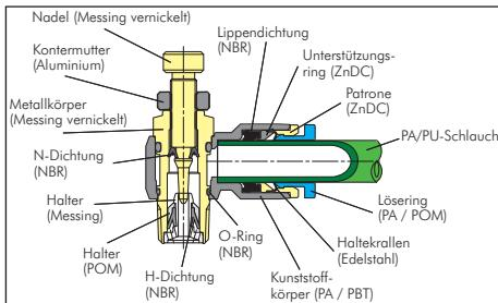
**Funktionsprinzip:** Drosselrückschlagventile drosseln den Durchfluss in einer Richtung, in der anderen Richtung ist der Durchfluss ungedrosselt. Standardform sind die Drosselrückschlagventile „abluftregelnd“. Sind diese in z.B. einen Zylinder eingeschraubt, ermöglichen diese einen gleichmäßigen Lauf ohne Slip-Stick-Effekt. Bei Zylindern mit kleinem Volumen (kleiner Durchmesser/geringer Hub), werden Drosselrückschlagventile in der Sonderform „zuluftregelnd“ eingesetzt.
