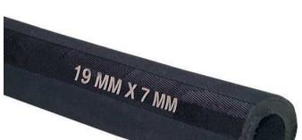
**Hinweis:** Dieser Schlauch ist konstruktiv auf 12 bar Arbeitsdruck ausgelegt. Aus Sicherheitsgründen schreibt die EN ISO 3861 einen max. Arbeitsdruck von 6,3 bar vor.
