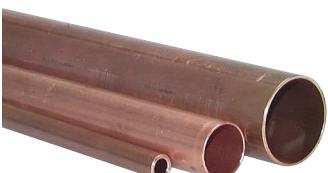
\* Industriequalität EN 12449 (R 200), \*\* Der maximal zulässige Betriebsdruck wurde auf Basis weicher Kupferrohre (R 200) und einem Sicherheitswert von 3,5 bei einer Betriebstemperatur von +100 °C berechnet. Der zulässige Betriebsdruck bezieht sich auf das Kupferrohr, nicht auf die Verbindungsteile! Die Werte für härtere Rohre sind höher.
