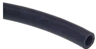
Werkstoffe: Decke: EPDM, schwarz, glatt, abriebfest, alterungs- und witterungsbeständig, nitrosaminfrei, Druckträger: hochfeste, synthetische Textilfäden, Seele: EPDM, schwarz, glatt, nitrosaminfrei
