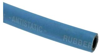
Werkstoffe: Innenseite: NBR/SBR schwarz, glatt, antistatisch, Außendecke: SBR/EPDM blau, glatt, abrieb-, witterungs- und ölfest, Gewebeeinlage: spiralierte, synthetische Textilfäden
