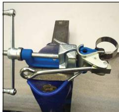
Spannen Sie das Spannwerkzeug in den Schraubstock ein. Setzen Sie den Adapter auf die Werkzeugnase. Führen Sie die Schelle in das Werkzeug ein. Halten Sie das Bandende mit dem Exenterheben fest.
