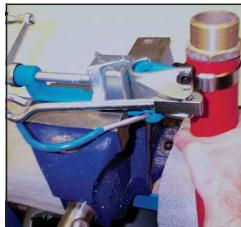
Stecken Sie den Schlauch durch die Schelle und drehen die Kurbel des Spannwerkzeuges nach rechts bis die gewünschte Spannung erreicht ist. Wenn sich das Band nicht mehr durch die Schlaufe zieht, ist die maximale Zugkraft erreicht. Die Bewegung des Bandes kann leicht durch Auflegen des Fingers „erfüllt“ werden.
