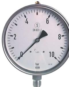
Verwendung: Manometer für besondere Sicherheit nach S 3 EN 837-1 (DIN 16006) mit ausblasbarer Rückwand und bruchsicherer Trennwand
