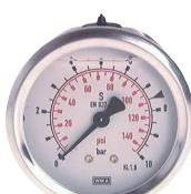
Werkstoffe: Gehäuse: 1.4301, Messsystem: Cu-Legierung (Drücke > 400 bar: 1.4404), Anschluss: Messing, Sichtscheibe: Kunststoff glasklar
