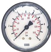
Werkstoffe: Gehäuse: Kunststoff schwarz, Messsystem und Anschluss: Cu-Legierung, Sichtscheibe: Kunststoff glasklar
