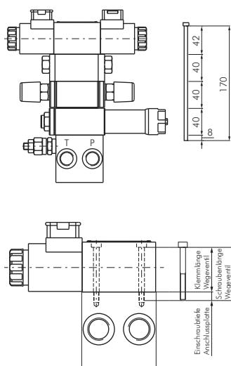
$$\text{Schraubenlänge des Wegeventils} + \text{Gesamtklemmlänge der Zwischenplattenventile} = \text{Gesamtschraubenlänge}$$
