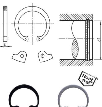
Augenform für Bohrung-Ø 11 - 12 - 14 - 16 - 18 - 19 - 21 - 22 - 24 - 25 - 27 - 29 - 30 - 32 - 33 - 35 - 36 - 38 - 40 - 41 - 43 - 44 - 46 - 48 - 49 - 51 mm
