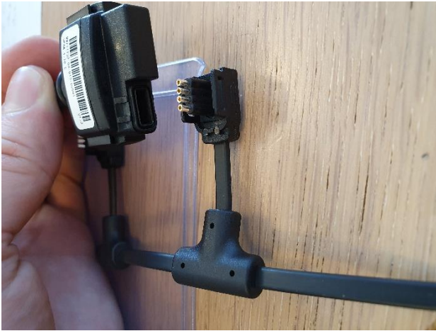
5. Depois de substituir os sensores ou o cabo, você pode conectar os novos sensores e cabos.
