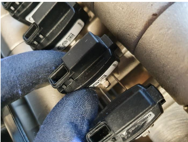
3. Quando o pino é puxado o suficiente, o sensor não fica mais travado no lugar.
