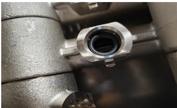
5. Verifique se o sensor foi removido corretamente. Remova qualquer coisa dos canos, como o anel O, que normalmente fica preso.
