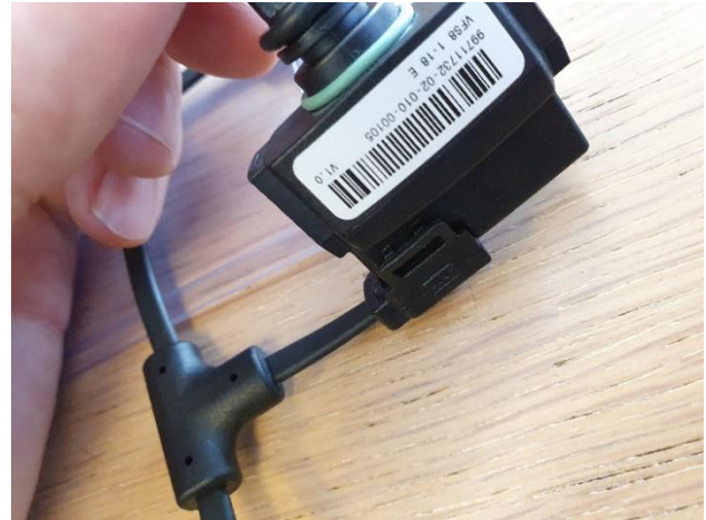
6. Coloque os sensores, de forma que eles repousem no cabo e verifique se os sensores e o cabo estão alinhados.
