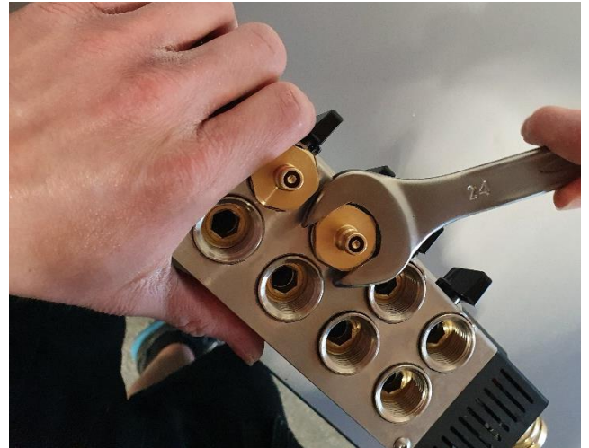
4. Continue montando os acessórios nos demais canais
