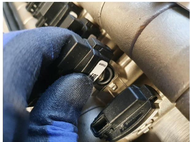
4. Remova o sensor puxando-o para fora
