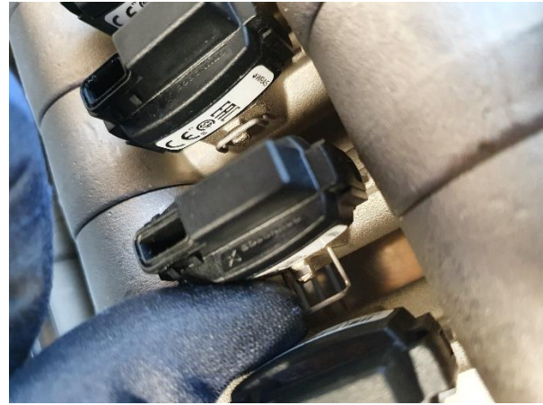
2. Puxe o pequeno pino de trava na lateral da tubulação.
