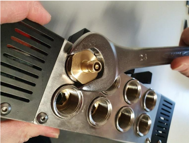
3. Aperte bem o acessório, para garantir que o coletor não vaze.
