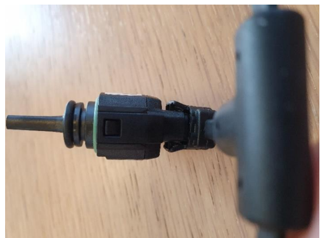
8. Certifique-se de que o encaixe dos dois lados bloqueie o sensor. Faça isso para todos os sensores e cabos.
