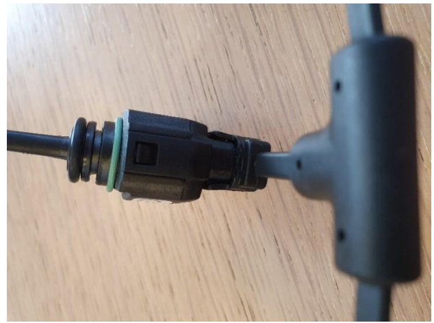
8. Certifique-se de que o encaixe dos dois lados bloqueie o sensor. Faça isso para todos os sensores e cabos.
