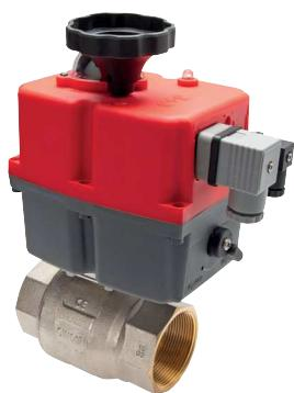
**Kugelhahn****Werkstoffe:** Gehäuse: Messing vernickelt, Kugel: Messing hartverchromt, Dichtung: PTFE/NBR**Temperaturbereich:** -20°C bis max. +150°C**Einsatzbereich:** Trinkwasser, Wasser, Druckluft, Vakuum (max. -0,9 bar)**Schwenkantrieb**
