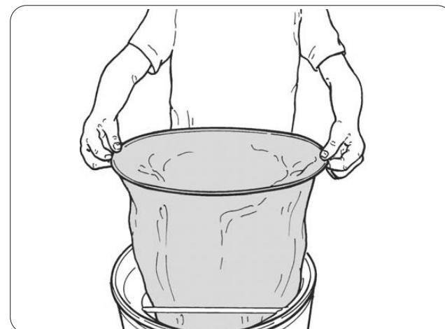
Se vi sono detriti all'interno del filtro oppure il filtro risulta forato è possibile sollevare tutto il gruppo filtrante mediante le apposite maniglie e procedere a parte all'estrazione del filtro e alla pulizia del portafiltro.
