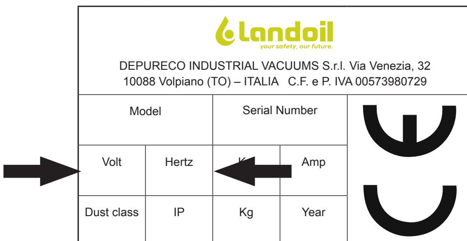
La presa di corrente per alimentare l'aspiratore deve essere protetta da un sezionatore di rete a norme CE. Inserire infine la spina (dotazione di serie) nella presa di corrente.
