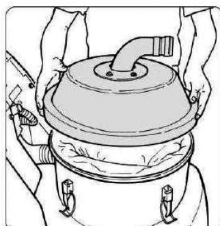
5. sfilare il filtro e sostituirlo con un ricambio originale
