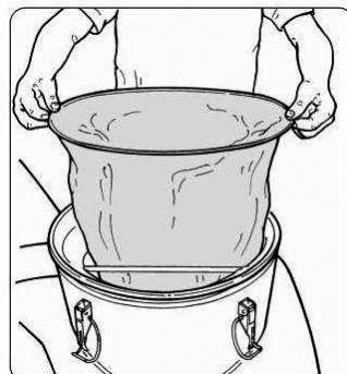
6. se vi sono detriti all'interno del filtro oppure se questo risulta forato, è possibile sollevare tutto il gruppo filtrante mediante le apposite maniglie e procedere a parte all'estrazione del filtro e alla pulizia del portafiltro
