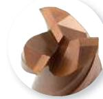
Fresa de 3 cortes, corte al centro, Hélice Variable con recubrimiento TiAlSiN.
