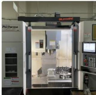
Pode utilizar o modelo CNC Doormatic de duas portas com unidade única para as suas máquinas CNC de duas portas. Disponibilizamos modelos com servomotores, com capacidade de até 400Kgf. Tabela de tamanhos disponíveis na imagem abaixo.
