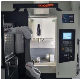
Pode utilizar o modelo de porta única CNC Doormatic para as suas máquinas CNC com uma única porta. Disponibilizamos modelos com servomotores, com capacidade de até 400Kgf. Tabela de tamanhos disponíveis na imagem abaixo.
