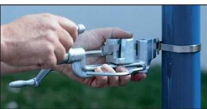
Band in das Spannwerkzeug seitlich einführen, Excenterhebel andrücken und durch Drehen der Kurbel Schelle anziehen. Die maximale Spannung ist erreicht, wenn das Band nicht mehr unter der Schlaufe durchzieht (lässt sich durch Auflegen eines Fingers leicht „erfühlen“).
