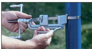
Nach Erreichen der erforderlichen Spannung das Werkzeug langsam über die Schlaufe biegen. Dabei gleichzeitig die Kurbel ca. eine halbe Umdrehung lösen, um Spannungsverlust und Reißen des Bands zu vermeiden. Um das Band abzuschneiden, Schneidehebel ruckartig ziehen.
