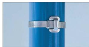
Mit dem Hammer das Band auf die Schlaufenbrücke schlagen und zur Sicherung des Bandendes die beiden Ohren der Schlaufe umlegen.
